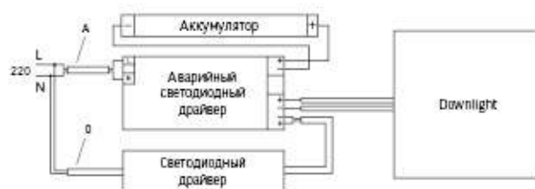
Рис. 2 Схема подключения аварийного светильника
